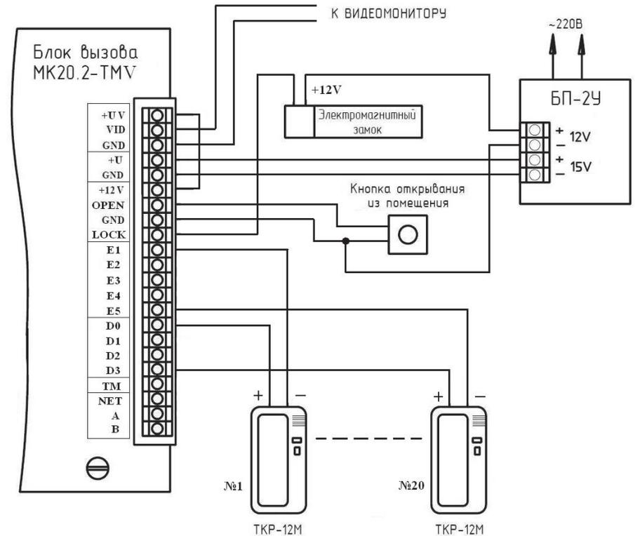
Рис. 2 Пример монтажа блока вызова МК20.2-TMV
