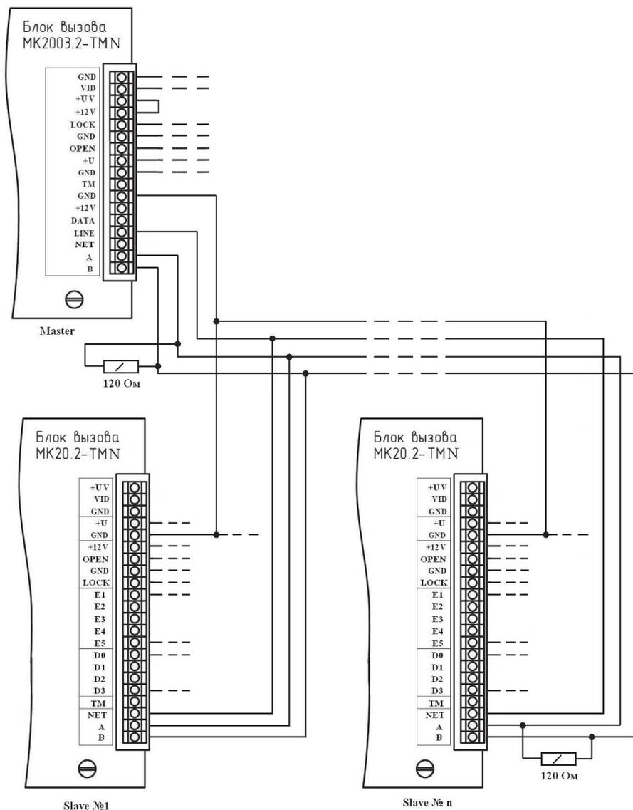
Рис. 3 Пример монтажа при объединении домофонов в сеть.
